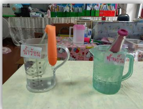
ผลการทดลอง ลูกโป่งพองโตและ ลูกโป่งถูกดูดลงไปในขวด
